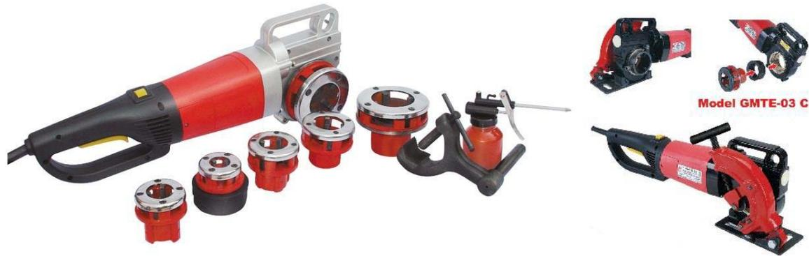
手持式电动套丝机与台式电动套丝机相比，重量轻，主机仅重 4 公斤；可快速更换板牙头；操作省力、快捷，携带方便；不受场地限制，在工地上或者非常规的场合均可灵活操作。本产品适用于工矿企业、院校、家庭维修、中小型工程队，可用于对供热、自来水、暖气、燃气等施工时的操作。本产品支持采用标准管子。
